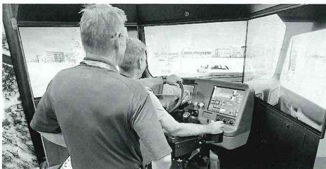
写真4 除雪機械運転シミュレーター
