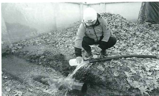
地下水採水の様子（地下水温15.7℃）
