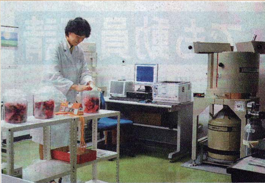
県産牛肉の放射性物質検査を行う日本環境科学の検査員。専用の容器に入れた牛肉をゲルマニウム半導体検出器(右)にかけて測定する =山形市高木
