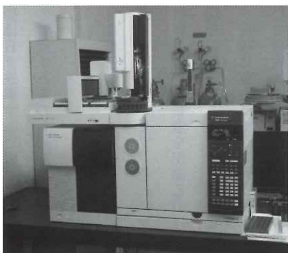
トリプル四重極ガスクロマトグラフ質量分析装置（GC-MS/MS）
