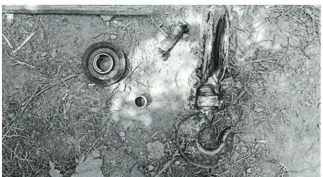
破損した動滑車
