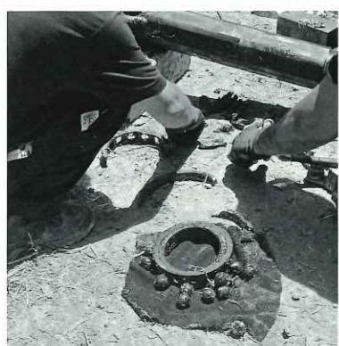
掘削機ベアリング部の破損
